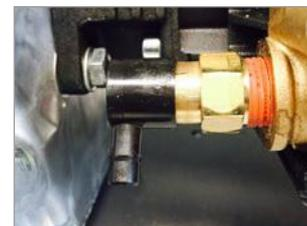
VÁLVULA TERMOSTÁTICA PARA PROTEGER LA BOMBA DE UN POSIBLE RECALENTAMIENTO DURANTE EL BY-PASS
